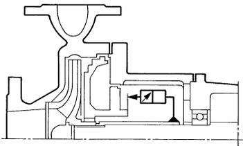
**Planlauf** der vertikalen Anschlussfläche des Dichtraumes zur Wellenachse:
