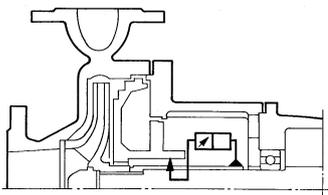
**Mittenversatz** (Exzentrizität) der inneren Oberfläche des Dichtraumes zur Welle:
